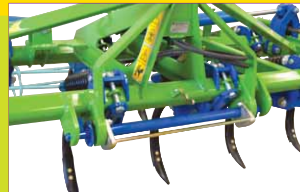
Barra de enganche rápido Bar of rapid hooking Barre d'attelage rapide
